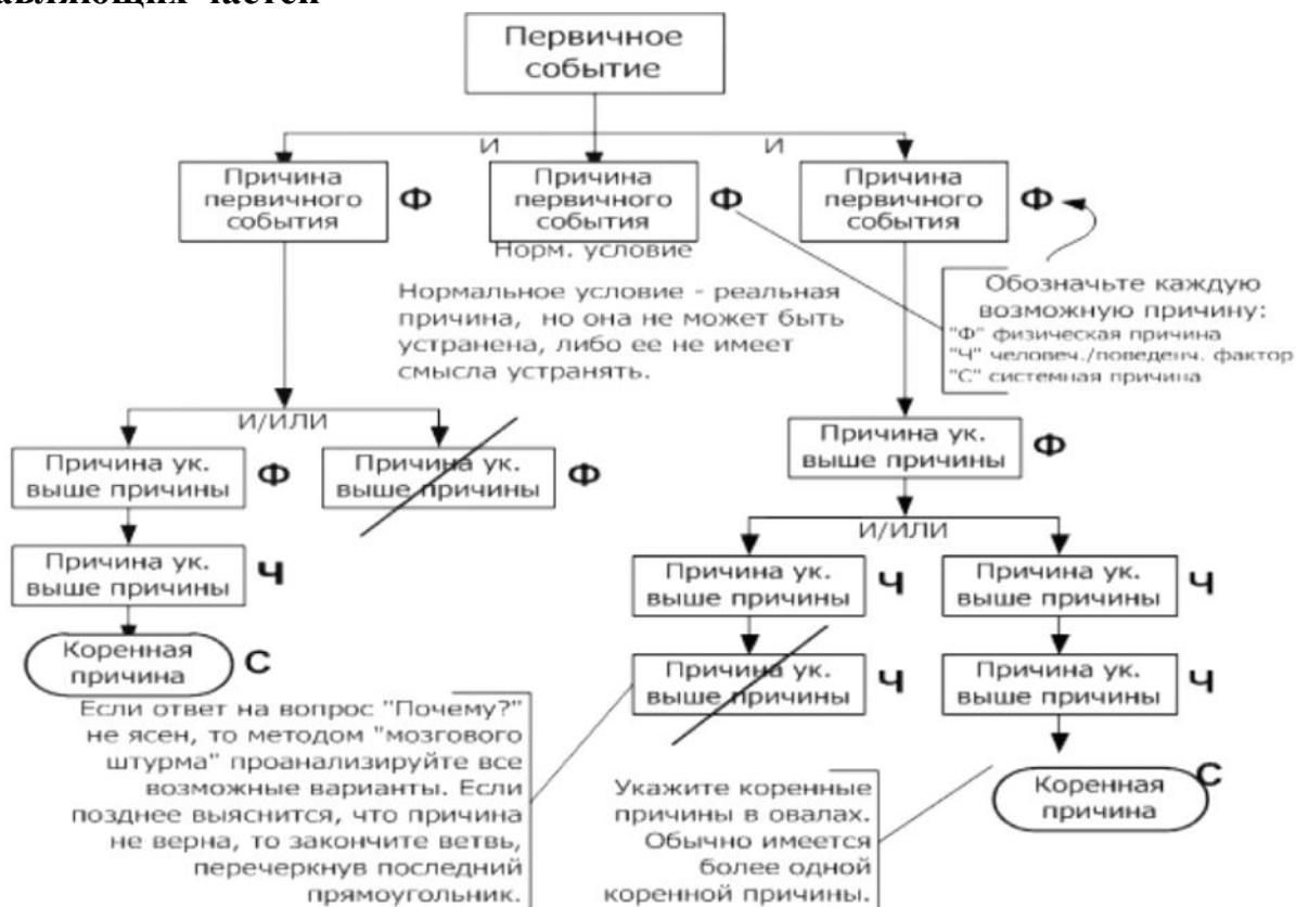
Схема 3. Пример построение схемы «Дерева причин» с указанием составляющих частей
